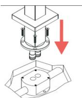
3. Se colocan la mangueras del monomando en el cuerpo sujetando el monomando al cuerpo con los tornillos.
