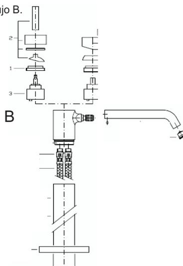
**NOTA: Utilice cinta de teflón en las roscas para la conexión a la red hidráulica para garantizar el sello.**
