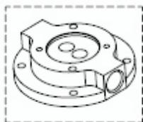
1.- Barrene el piso acorde a las medidas del cuerpo del monomando e identifique las tomas de agua (Fría y caliente) y efectué las conexiones correspondientes. Posteriormente verificar que no exista fuga.
