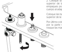
2. Coloque la base adaptador del desviador por la parte superior de la tina, posteriormente rosque las tuercas y empaques por la parte inferior. Posteriormente conecte el cuerpo al adaptador.
