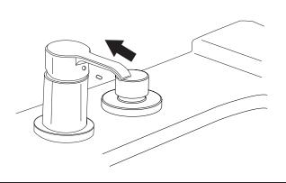
8.- Coloque la nariz al cuerpo y fíjelo roscando el opresor con ayuda de una llave hexagonal, verificando que la nariz quede correctamente alineada.
