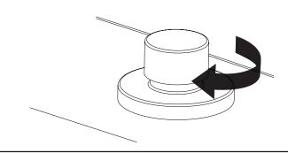
6.- Coloque el maneral en el cuerpo y fíjelo roscando el opresor con ayuda de una llave hexagonal.
