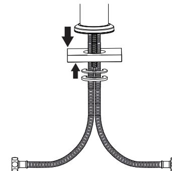
4- Verifique que las mangueras y el birlo queden en el interior del empaque y de la rondana tipo M. Alinee su monomando y rosque firmemente la tuerca. Conecte las mangueras a la alimentación de agua.
