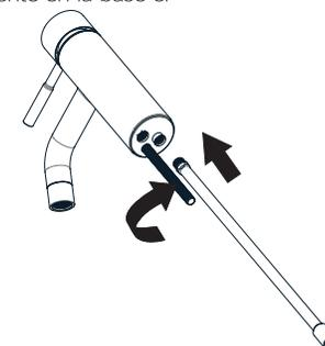
2- Coloque la extensión en el cuerpo del monomando, deslice el chapetón y el anillo de hule por la parte inferior del monomando.
