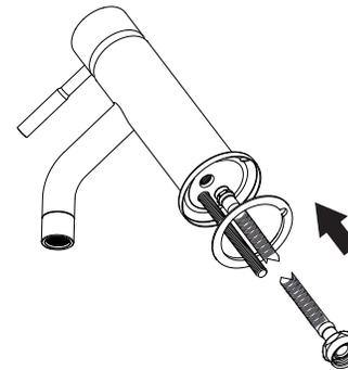
3.- Introduzca el birlo y mangueras del monomando a través del barreno central del mueble, asegúrese que el chapetón quede bien colocado y firme contra el mueble. Por la parte inferior del mueble introduzca el empaque tipo M y la rondana tipo M.
