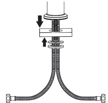
4.- Verifique que las mangueras y el birlo queden en el interior del empaque y de la rondana tipo M. Alinee su monomando y rosque firmemente la tuerca. Conecte las mangueras a la alimentación de agua.
