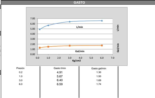
"En caso de instalar el producto a una presión distinta a la indicada alterará el funcionamiento y el consumo de agua del mismo"
